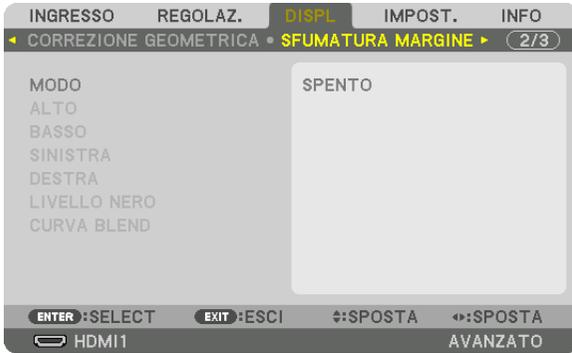
Regola i bordi (confini) dello schermo di proiezione quando si proiettano video ad alta risoluzione mediante una combinazione di più proiettori nelle posizioni alta, bassa, sinistra e destra.
