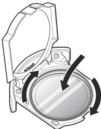
A seconda della loro forma, alcuni filtri non possono essere usati con il supporto del filtro slip-in (da infilare). Utilizzare filtri che si adattano al supporto.
