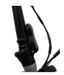
Ruotare l'anello di sicurezza per evitare che la leva di fissaggio si sblocchi accidentalmente
