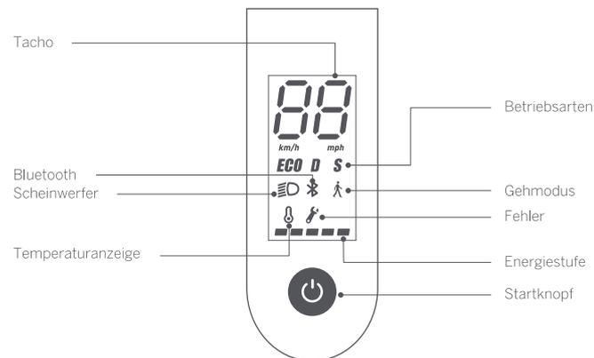
**Startknopf:** Zum Einschalten kurz drücken. Die Taste 3 Sekunden lang gedrückt halten, um den Roller auszuschalten. Wenn der KickScooter eingeschaltet ist, drücken Sie die Taste, um das Scheinwerfer und Rückleuchte ein- / auszuschalten, Doppelklick, um den Powermodus zu ändern.
