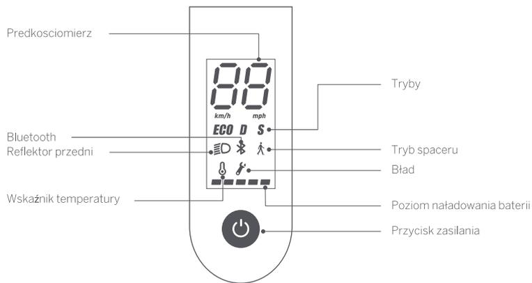
**Przycisk zasilania:** naciśnij, aby włączyć hulajnogę; naciśnij i przytrzymaj przycisk przez 3 sekundy, aby wyłączyć hulajnogę. Gdy hulajnoga jest włączona, żeby wyłączyć/włączyć reflektor przedni i tylne światło naciśnij przycisk. naciśnij dwukrotnie, aby przełączyć tryb.
