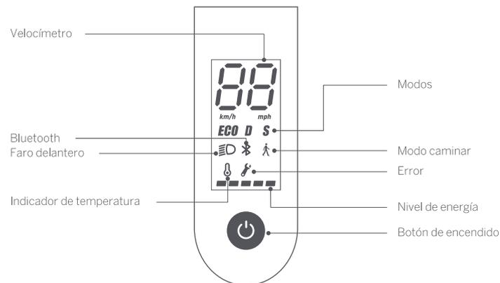
**Botón de encendido:** Pulsación breve para encender. Mantenga presionado el botón tres segundos para apagar el patinete. Cuando el patinete está encendido, aprete el botón para encender o apagar la Faro delantero y luz trasera. Dos pulsaciones para cambiar el modo de energía.
