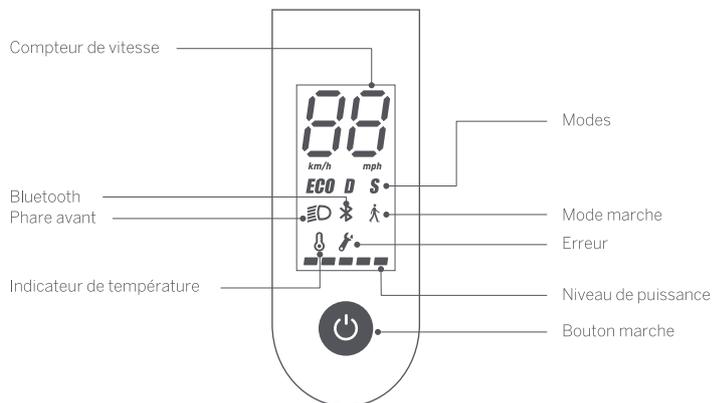
**Bouton marche :** Appuyez brièvement pour allumer. Appuyez sur le bouton pendant 3 secondes pour éteindre le KickScooter. Lorsque la trottinette électrique est allumée, appuyez sur le bouton allumer ou éteindre pour le phare avant et phare arrière.
