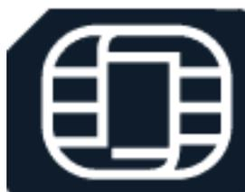
**Importante:** questo dispositivo è stato progettato per essere utilizzato solo con una carta nano SIM (v. figura). L'utilizzo di carte SIM incompatibili potrebbe danneggiare il dispositivo o la carta, nonché i dati memorizzati su di essa.
