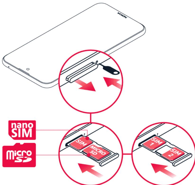
1. Aprire l'alloggiamento della scheda SIM: infilare la puntina per l'apertura nel foro dell'alloggiamento ed estrarre l'alloggiamento.
