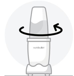
Déverrouillez l'assemblage en poussant et en dévissant doucement la tasse dans le sens antihoraire.
