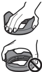
1 将镜头遮光罩上的标记①(□)对准镜头顶端的标记。
