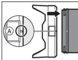
2 朝箭头指示的方向转动镜头遮光罩，以便将镜头遮光罩上的标记②(○)对准镜头顶端的标记。
