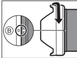
• 转动镜头遮光罩直至听到咔哒一声完成安装。
