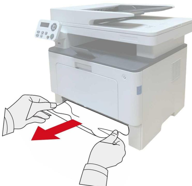
3. Dopo aver rimosso la carta inceppata, reinserire il vassoio automatico nella stampante; premere il pulsante del coperchio anteriore per aprire e chiudere il coperchio anteriore e far riprendere automaticamente il processo di stampa.
