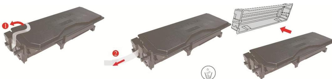
6. Inserire la cartuccia nel componente tamburo lungo il binario, per completare l'installazione della cartuccia.
