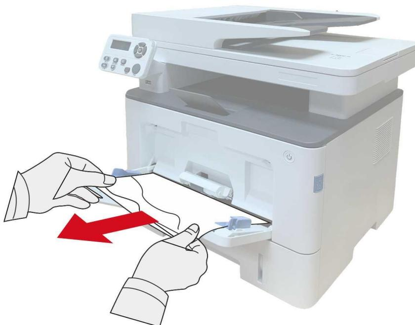
2. Dopo aver rimosso la carta inceppata, ricaricare la carta nel vassoio multiuso; premere il pulsante del coperchio anteriore per aprire e chiudere il coperchio anteriore e far riprendere automaticamente il processo di stampa.
