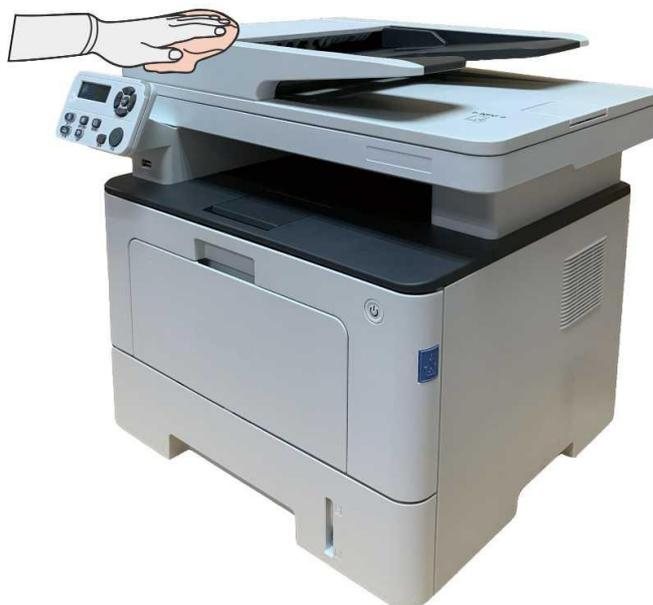
2. Solleva il coperchio dello scanner e pulisci con un panno morbido la lastra di vetro e l'alimentatore automatico di documenti fronte/retro CIS (D-CIS).
