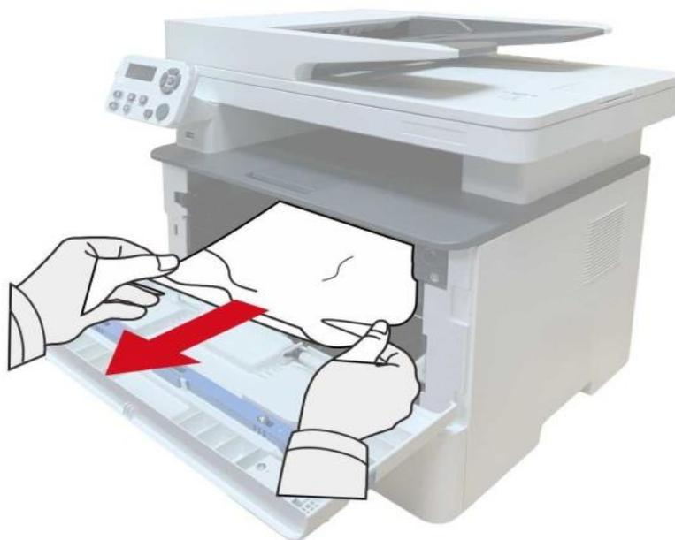
7. Dopo il rilascio di carta inceppata, reinstallare la cartuccia del laser, chiudere il coperchio anteriore e la stampante sarà necessario per la stampa.
