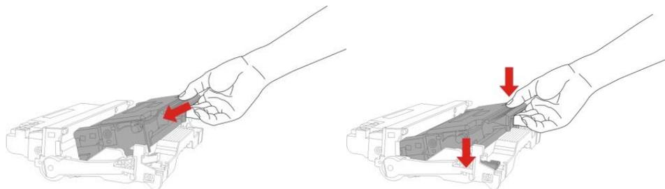
7. Prendere componente tamburo nella cartuccia installata, installare componenti tamburo con la cartuccia installata lungo il cursore stampante per completare l'installazione.
