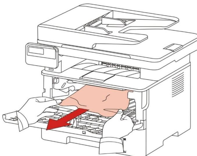
7. Dopo il rilascio di carta inceppata, reinstallare la cartuccia del laser, chiudere il coperchio anteriore e la stampante sarà necessario per la stampa.
