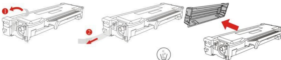
6. Inserire la cartuccia nel componente tamburo lungo il binario, per completare l'installazione della cartuccia.
