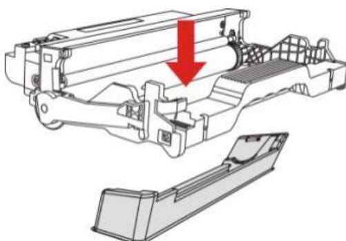
5. Inserire la cartuccia nel componente tamburo lungo il binario, per completare l'installazione della cartuccia.
