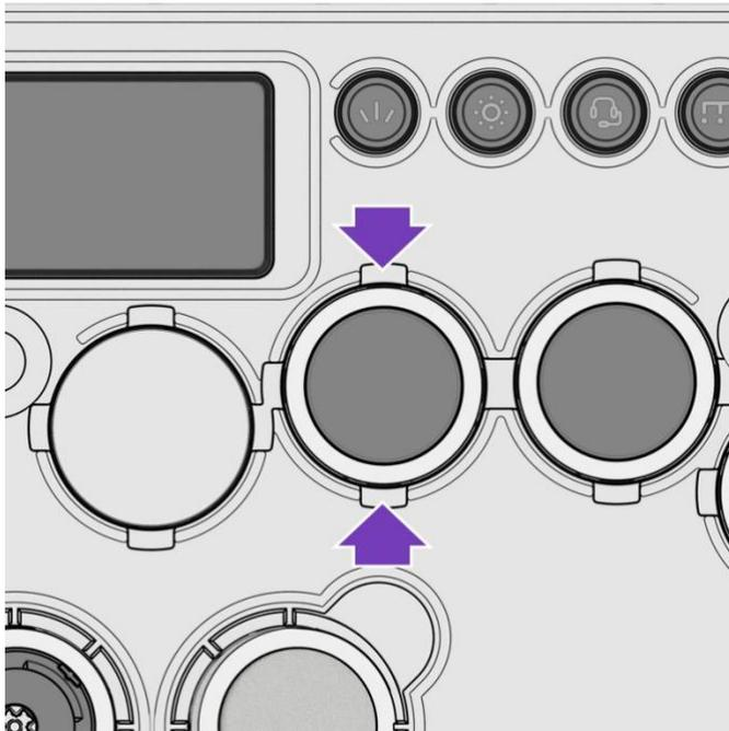
NN.スイッチプラーでボタンキャップを外します
