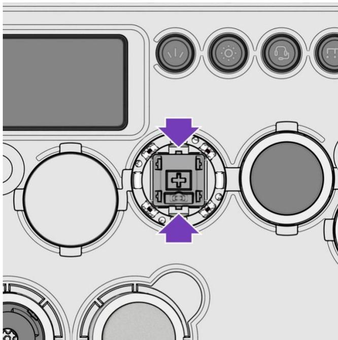
PP. スイッチの下にある金属接触ピンを損傷しないように注意しながら、スイッチを専用の収納場所に置きます
