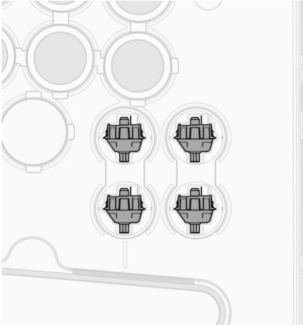
HH. Entferne den Aluminium-Tastenstecker aus dem Stauraum und raste ihn an der Stelle des soeben entfernten Schalters ein.
