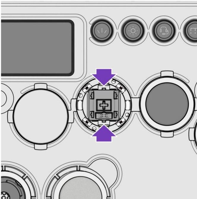
X. Coloca el botón en la zona de almacenamiento adecuada con cuidado de no dañar las patillas de contacto metálicas que tiene debajo.
