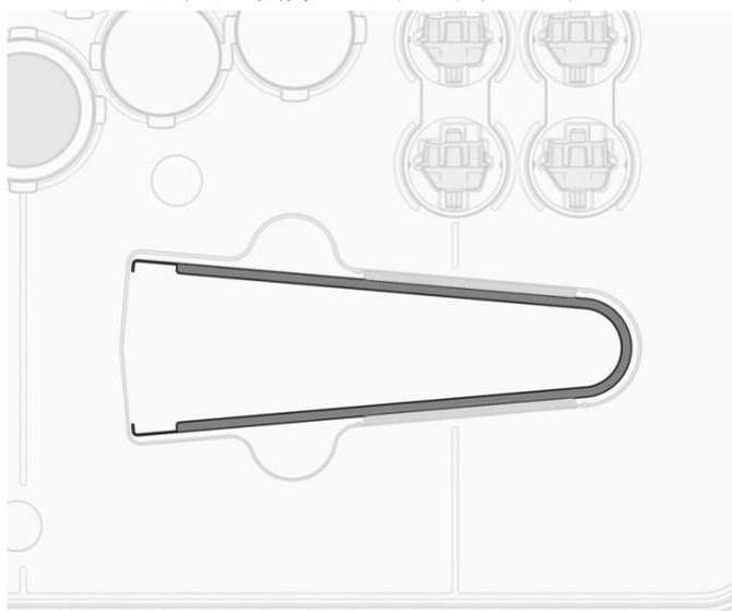
MM. スイッチプラーを変更したいボタンのライトリングのデボス加工部分に当て、しっかりと引き上げます
