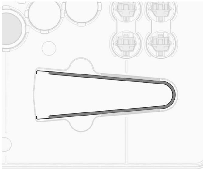
DD. Lege den Schalterabzieher um den geprägten Bereich des Lichtrings auf der Taste, die du austauschen möchtest, und ziehe sie fest nach oben.
