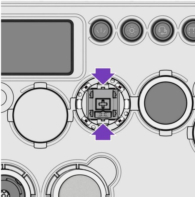
GG. Lege den Schalter in das dafür vorgesehene Fach und achte darauf, dass du die Metallkontaktstifte unter dem Schalter nicht beschädigst.
