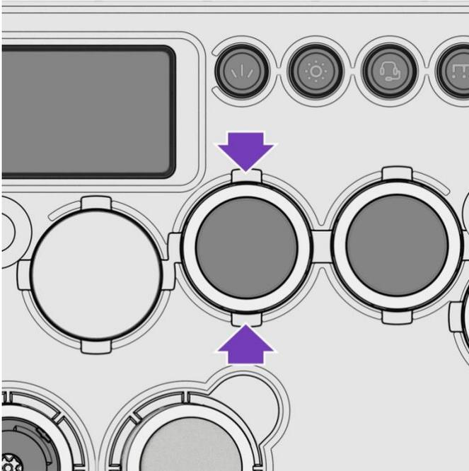
EE. Entferne die Tastenkappe mit dem Schalterabzieher.
