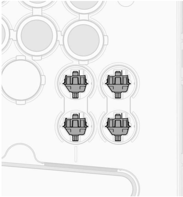
QQ. 収納場所からアルミボタンプラグを取り外し、取り外したスイッチの位置にカチッと音がするまではめ込みます
