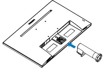
2. Tenere la base del monitor con entrambe le mani ed inserire con fermezza la base nel supporto.
