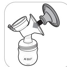
4. Umieść nakładkę w części głównej laktatora i upewnij się, że krawędź zakrywa część główną laktatora.
