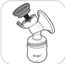
5. Setzen Sie die Silikonmembran in das Pumpengehäuse ein.
