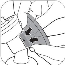
4A. Drücken Sie den inneren Teil des Kissens im Trichter gegen die Linie (mit einem Pfeil gekennzeichnet).
