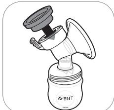
5. Placez le diaphragme en silicone dans le corps du tire-lait.
