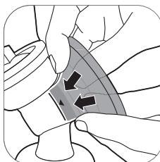
4A. Druk de binnenkant van het kussen in de trechter tegen de lijn (aangegeven met een pijl).
