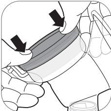
5A. Stellen Sie sicher, dass die Silikonmembran sicher auf dem Rand sitzt, indem Sie sie mit den Daumen nach unten drücken.
