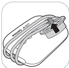
5. Wickeln Sie zur einfachen Aufbewahrung den Silikonschlauch um die Motoreinheit, und befestigen Sie die Kappe am Schlauch.
