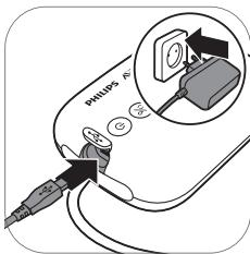
8. Steek de adapter in het stopcontact en steek de kleine stekker aan het andere uiteinde van het snoer in de motorunit.
