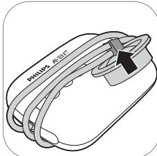
5. Wikkel het siliconenslangetje rond de motorunit en klik de dop vast aan het slangetje, zodat u het apparaat makkelijk kunt opbergen.
