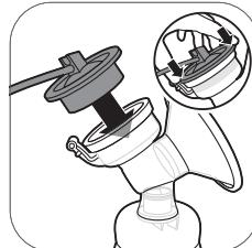
6. Posizionate il tubo in silicone e il coperchio sul diaframma in silicone. Spingete il coperchio finché non è posizionato correttamente in sede.
