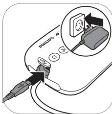
8. Collegate l'adattatore alla presa di corrente a muro e inserite lo spinotto all'altra estremità nel gruppo motore.
