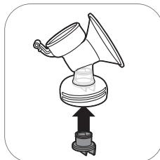
2. Stecken Sie das weiße Ventil so weit wie möglich in das Pumpengehäuse.
