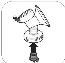
2. Inserite la valvola bianca nel corpo del tiralatte spingendola più a fondo possibile.
