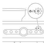
Die Anzeige für Dampf/Heißwasser blinkt weiß: Die Kaffeemaschine wird für die Verwendung der Heißwasser-/Dampffunktion aufgeheizt.
