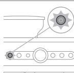
Η ένδειξη του κουμπιού On/Off αναβοσβήνει: Η μηχανή καφέ θερμαίνεται.
