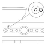
Lampen för avkalkning/rengöring lyser: Kalka av kaffemaskinen (se 'Avkalkning').
