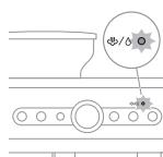
Die Anzeige für Dampf/Heißwasser blinkt rot: Die Kaffeemaschine zeigt einen Wassermangel an. Die Ursache kann 1. Wassermangel im Wasserbehälter oder 2. ein Pumpstopp aufgrund von Überdruck sein.
