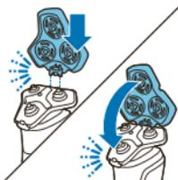
Nota: quando inserite nuovamente le testine di rasatura e fissate gli anelli di arresto, tenete in mano il relativo supporto, evitando di posizionarlo su una superficie, onde evitare danni alle testine di rasatura.
