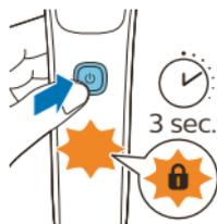
Potete disattivare il Bluetooth sul vostro rasoio attivando il blocco da viaggio.
