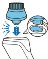
**1** Ruotate la testina di rasatura o un altro accessorio per rimuoverlo dal manico e premete la spazzola di pulizia sul manico per installarla.
