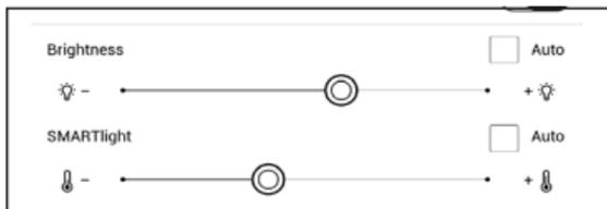
**1. Controllo frontlight generale.** Questa sezione include un interruttore **ON/OFF** che consente di accendere e spegnere la luce e un cursore di luminosità.
