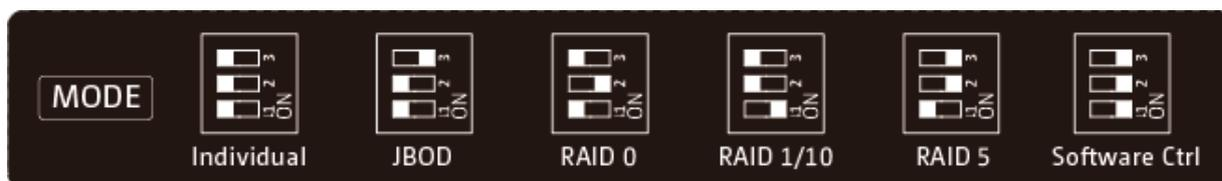
Le impostazioni RAID possono essere configurate manualmente utilizzando lo switch di modalità posto sul pannello posteriore dell'alloggiamento RAID, spostando gli switch sulle posizioni corrispondenti, come descritto sopra.
