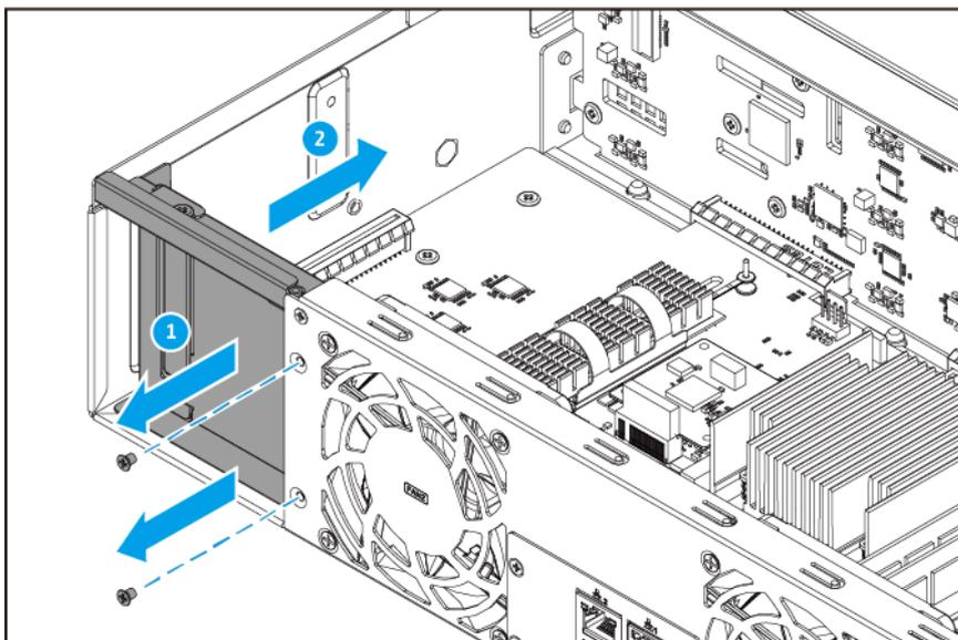
5. Installare la staffa PCIe a due slot con scheda riser.
