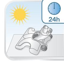
**FR** Pour nettoyer la tête, détachez d'abord le support de lingette, puis la tête du corps de l'appareil. Passez-la sous l'eau et utilisez une éponge si nécessaire. Laissez sécher complètement pendant 24 heures avant de la réinstaller.
