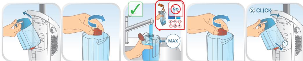
**FR** Remplissez le réservoir d'eau: détachez-le en soulevant la poignée. Dévissez le bouchon et remplissez le réservoir avec de l'eau du robinet. **Attention: ne pas ajouter de produits chimiques, détergents ou parfums.** Revissez le bouchon et replacez le réservoir d'eau dans l'appareil.
