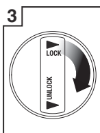
3 Rimontare e fissare il portachicchi.
