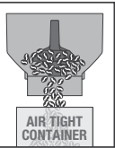
2 Tenir la trémie au-dessus du récipient et tourner le cadran pour libérer les grains dans le récipient
