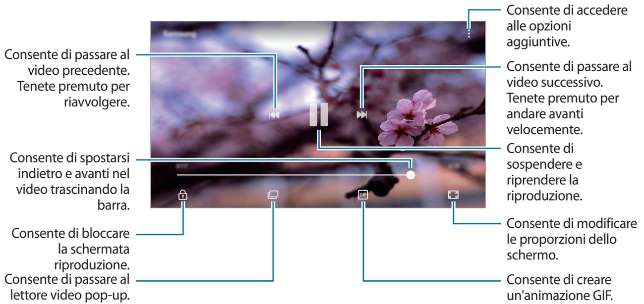
Trascinate il dito in alto o in basso a sinistra della schermata di riproduzione per regolare la luminosità, oppure trascinate il dito in alto o in basso a destra della schermata di riproduzione per regolare il volume.
