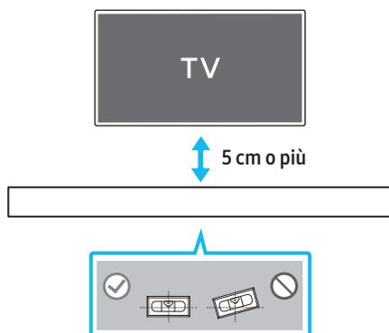
2. Allineare la **linea centrale della Guida per il montaggio a parete** con il centro della TV (se si è deciso di montare la Soundbar sotto alla TV) e fissare la **Guida per il montaggio a parete** al muro con del nastro adesivo.
