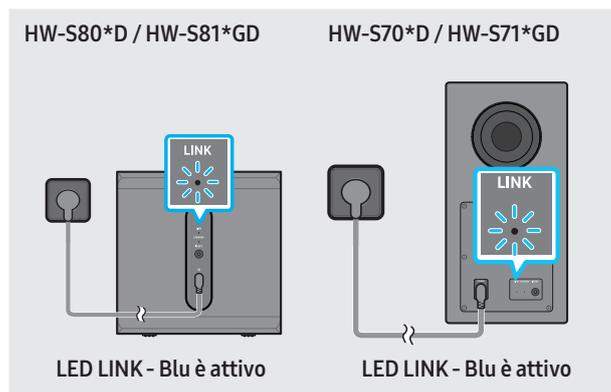
L'indicatore LED LINK (COLLEGAMENTO) smette di lampeggiare e la luce blu rimane fissa quando viene stabilita una connessione tra la Soundbar e il Subwoofer wireless.
