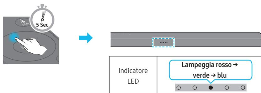
4. Assicurarsi che il LED LINK (COLLEGAMENTO) emetta una luce blu fissa (collegamento completato).
