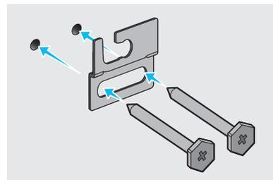
6. Installare le 2 **staffe di montaggio a parete** nell'orientamento corretto sulla parte posteriore della Soundbar utilizzando 2 **rondelle**.
