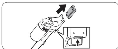
Premere il tasto di sgancio della batteria posto sul retro del manico ed espellere la batteria.
