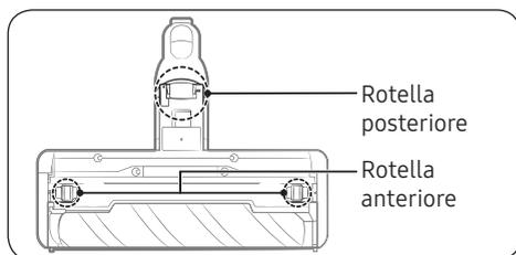
Usare un piccolo cacciavite per smontare le ruote a rullo anteriore e posteriore.
