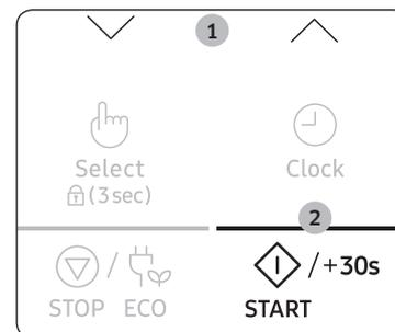
1. Inserire il cibo nel forno. Quindi selezionare il tempo di cottura premendo il tasto **Su** e **Giù**. Sul display viene visualizzato il tempo di cottura impostato.
