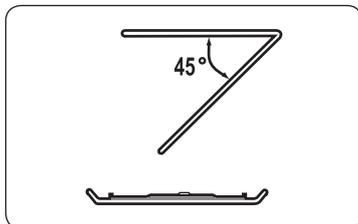
Per la pulizia dell'area superiore del vano cottura, abbassare l'elemento riscaldante superiore di 45° come mostrato. Ciò consentirà di pulire l'area superiore in modo più agevole. Al termine, riposizionare l'elemento riscaldante superiore.
