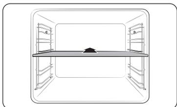
Inserire il divisorio nel livello 3 per separare il vano cottura in due compartimenti. Il forno rileva il divisorio ed attiva il comparto superiore come impostazione predefinita.
