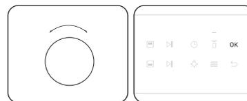
4. Ruotare il **Selettore dei valori** per selezionare un tempo di pulizia scegliendo tra 3 livelli: 1 ora 50 min, 2 ore 10 min, e 2 ore 30 min.
