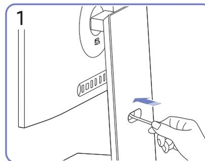
Far passare i cavi tramite il foro sul supporto.
