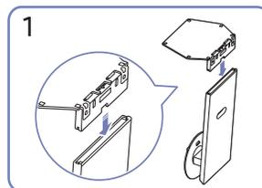
Inserire la base del piedistallo nel connettore seguendo la direzione indicata nella figura. Verificare che il connettore del piedistallo sia saldamente fissato.
