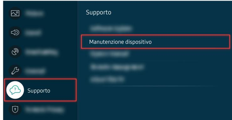
Per verificare l'uscita audio, selezionare > **Impostazioni** > **Supporto** > **Manutenzione dispositivo** > **Auto diagnosi** > **Test audio**.
