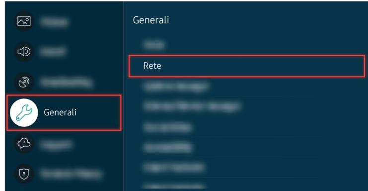
Se il problema persiste, selezionare > **Impostazioni** > **Generali** > **Rete** > **Stato rete** > **Impost. IP** per cambiare il server DNS. Qualora si verificasse un test, annullarlo e selezionare **Impost. IP**.
