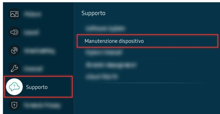
Accedere a > Impostazioni > Supporto > Manutenzione dispositivo > Auto diagnosi > Test audio per verificare l'audio.
