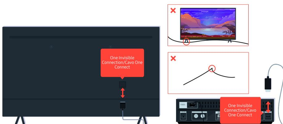
Se il problema persiste ed il proprio TV usa il One Invisible Connection o Cavo One Connect, scollegare e ricollegare il One Invisible Connection o Cavo One Connect al TV ed alla One Connect Box. Accertarsi che il One Invisible Connection o Cavo One Connect non sia schiacciato o piegato eccessivamente.
