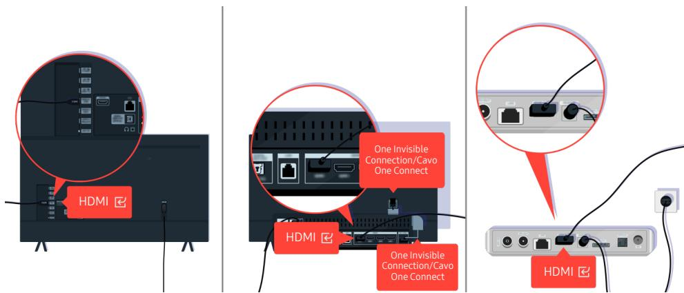
Verificare la connessione del cavo HDMI al proprio TV o One Connect Box.
