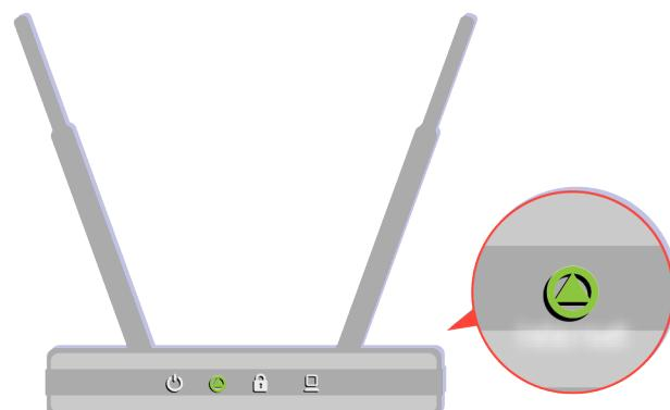
Accertarsi che l'access point utilizzato funzioni regolarmente. Controllare le spie LED dell'access point per verificare il regolare funzionamento.
