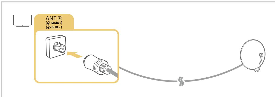
È consigliabile collegare entrambi i connettori usando il Multi-Switch o lo Switch DiSEqC, ecc ed impostare **Tipologia connessione antenna a Doppio**.
