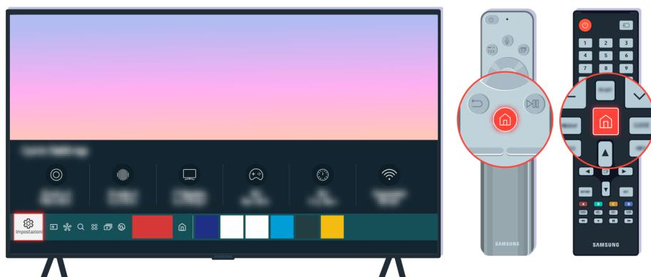
Se il problema persiste, selezionare > **Impostazioni** > **Generali** > **Rete** > **Stato rete** > **Impost. IP** per cambiare il server DNS. Qualora si verificasse un test, annullarlo e selezionare **Impost. IP**.
