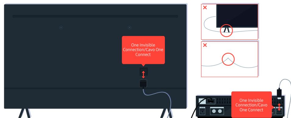
Scollegare e ricollegare il cavo One Invisible Connection o Cavo One Connect tra il TV e la One Connect Box.
