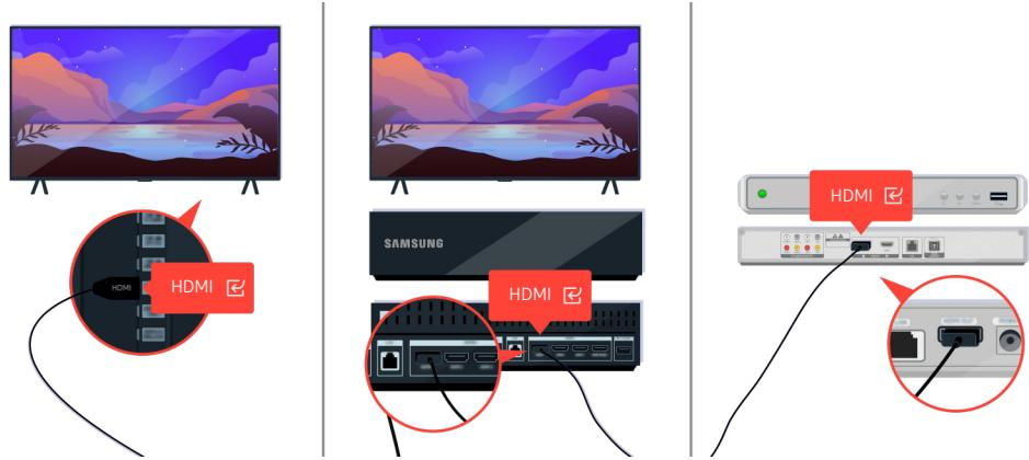
Se il problema persiste, provare a collegare un altro dispositivo esterno al TV mediante un cavo HDMI. Se il display è corretto, il dispositivo esterno potrebbe essere difettoso.
