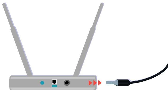
Provare a riavviare l'access point scollegando e ricollegando il cavo di alimentazione. Potrebbero essere necessari da 1 a 2 minuti prima che l'access point torni online dopo un riavvio.
