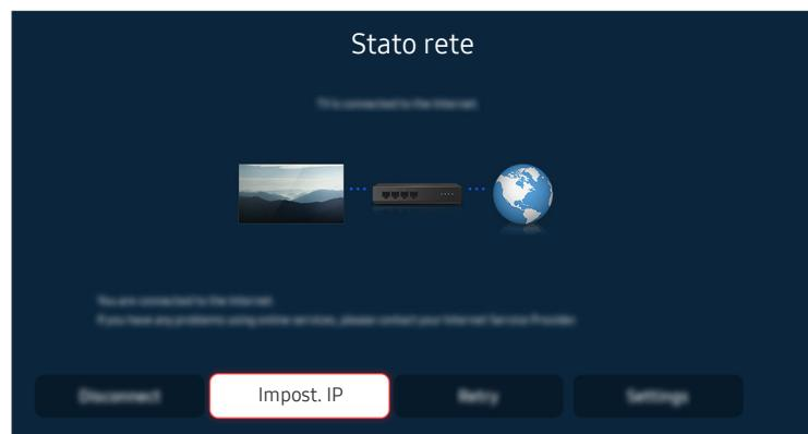
Se il problema persiste, selezionare > **Impostazioni** > **Generali** > **Rete** > **Stato rete** > **Impost. IP** per cambiare il server DNS. Qualora si verificasse un test, annullarlo e selezionare **Impost. IP**.
