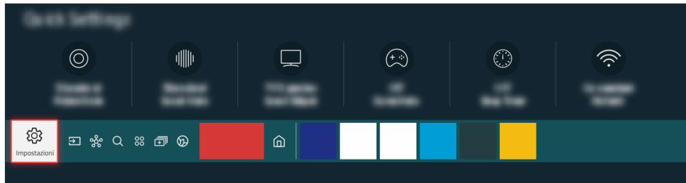
Accedere a > Impostazioni > Supporto > Manutenzione dispositivo > Auto diagnosi > Test audio per verificare l'audio.
