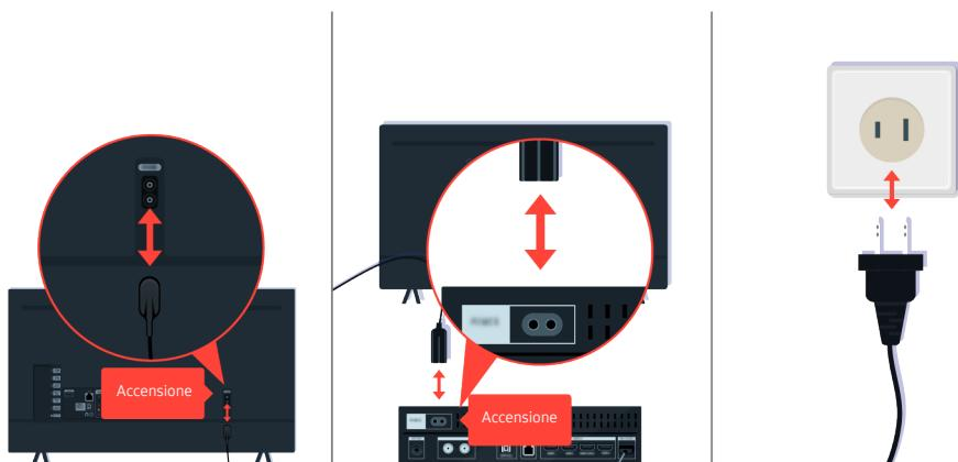
Scollegare e ricollegare i cavi di alimentazione ed i cavi HDMI sul retro del TV o della One Connect Box, quindi scollegare il cavo di alimentazione e ricollegarlo ad una presa elettrica a parete.
