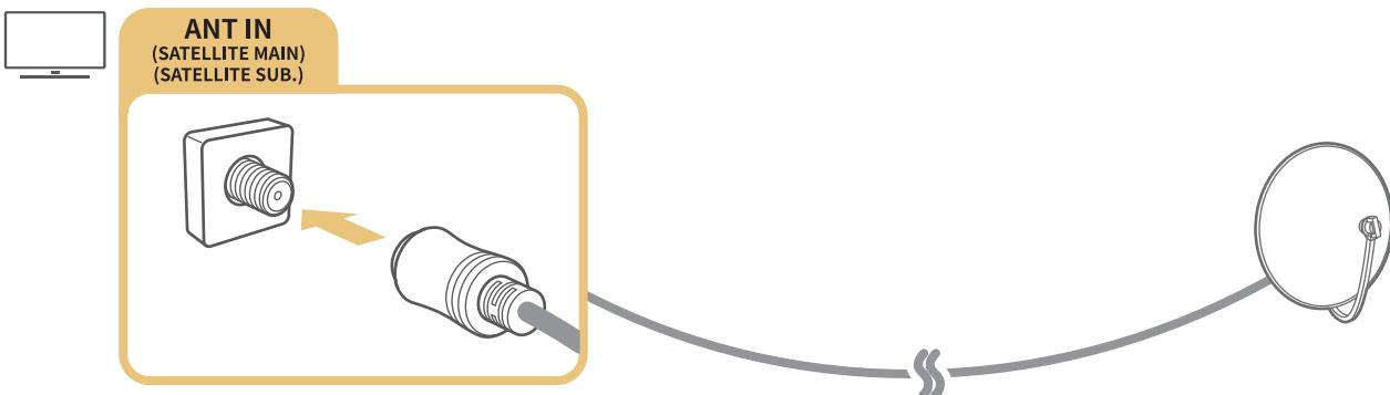
È consigliabile collegare entrambi i connettori usando il Multi-Switch o lo Switch DiSEqC, ecc ed impostare [Tipologia connessione antenna](#) a **Doppio**.
