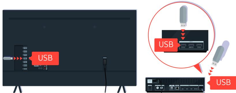
Inserire il dispositivo USB in uno slot USB sul retro del TV o sul lato della One Connect Box.
