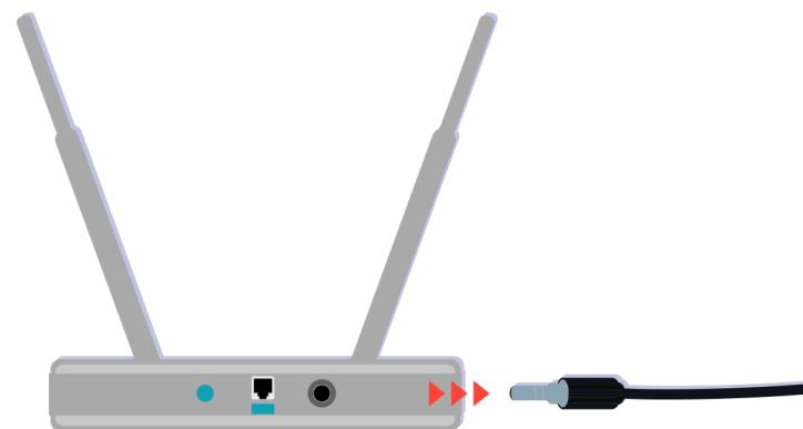
Provare a riavviare l'access point scollegando e ricollegando il cavo di alimentazione. Potrebbero essere necessari da 1 a 2 minuti prima che l'access point torni online dopo un riavvio.
