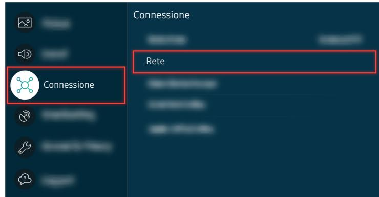
Se il problema persiste, selezionare > **Menu** > **Impostazioni** > **Tutte le impostazioni** > **Connessione** > **Rete** > **Stato rete** > **Impost. IP** per passare a un altro server DNS. Qualora si verificasse un test, annullarlo e selezionare **Impost. IP**.
