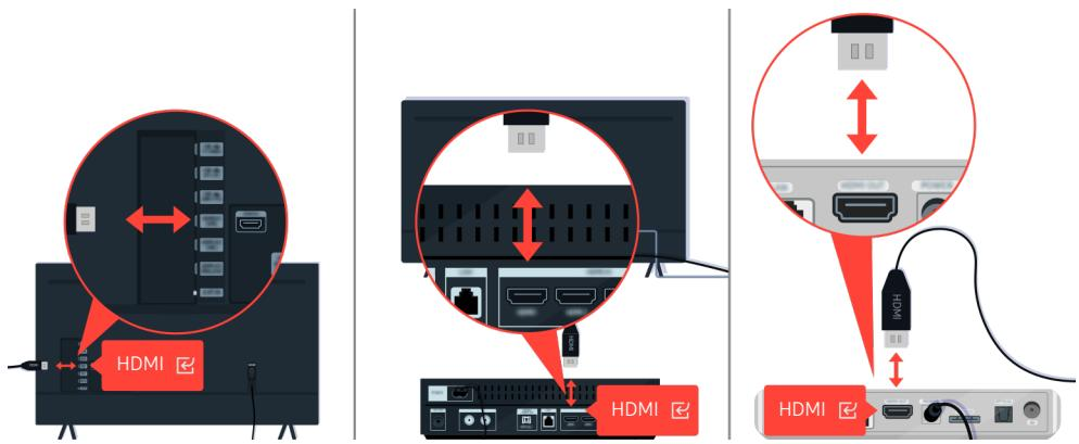
Scollegare e ricollegare i cavi di alimentazione e i cavi HDMI sul retro del TV o della One Connect Box, quindi scollegare il cavo di alimentazione e ricollegarlo a una presa a muro.
