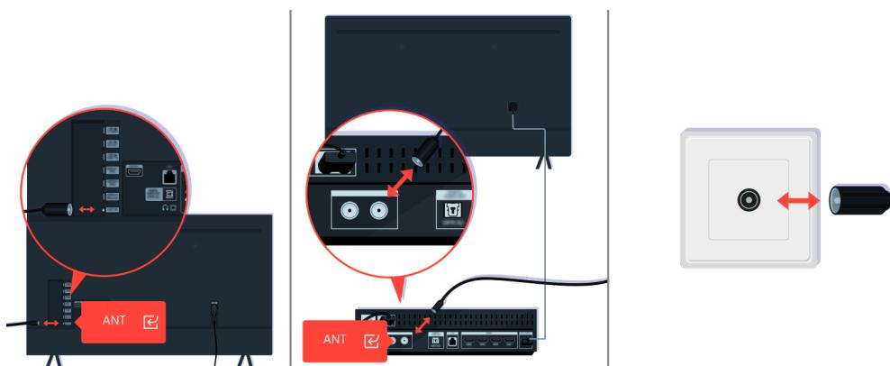
Controllare la connessione dei cavi dell'antenna e degli ingressi.
