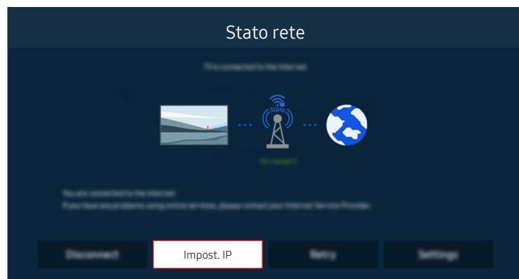
Se il problema persiste, selezionare > **Menu** > **Impostazioni** > **Tutte le impostazioni** > **Connessione** > **Rete** > **Stato rete** > **Impost. IP** per passare a un altro server DNS. Qualora si verificasse un test, annullarlo e selezionare **Impost. IP**.
