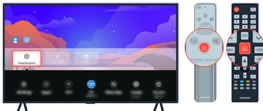
Se il problema persiste, selezionare > **Menu** > **Impostazioni** > **Tutte le impostazioni** > **Connessione** > **Rete** > **Stato rete** > **Impost. IP** per passare a un altro server DNS. Qualora si verificasse un test, annullarlo e selezionare **Impost. IP**.
