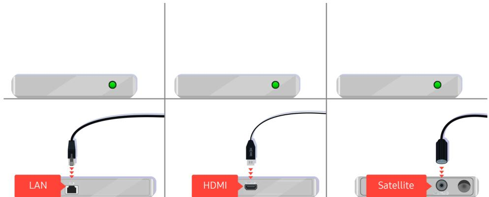
In caso di uso di un set-top box, verificare la connessione del cavo. Il cavo da controllare dipende dal tipo di set-top box utilizzato.
