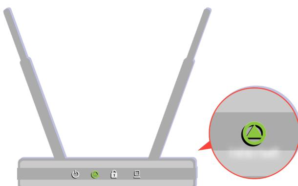
Accertarsi che l'access point utilizzato funzioni regolarmente. Controllare le spie LED dell'access point per verificare il regolare funzionamento.
