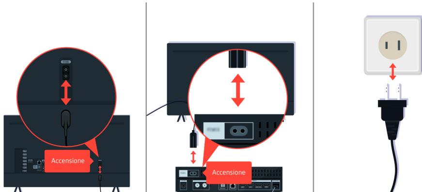
Scollegare e ricollegare i cavi di alimentazione e i cavi HDMI sul retro del TV o della One Connect Box, quindi scollegare il cavo di alimentazione e ricollegarlo a una presa a muro.
