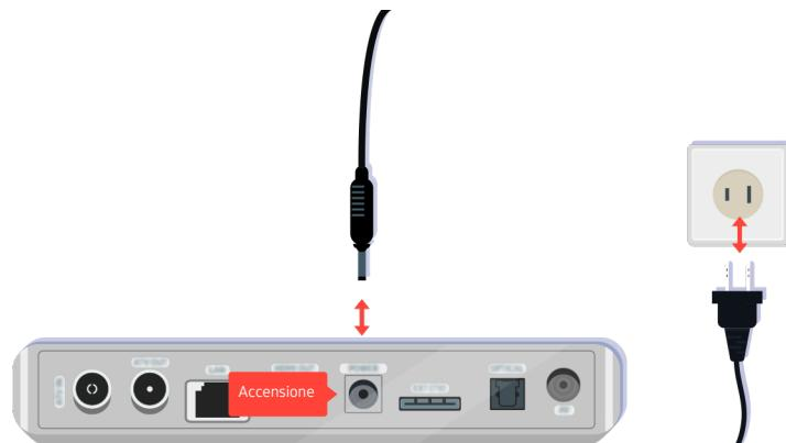
Qualora non si accenda, accertarsi che il cavo di alimentazione sia correttamente collegato al dispositivo ed alla presa di corrente
