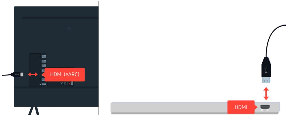
Se la soundbar non emette alcun suono ed è collegata al TV con un cavo HDMI, verificare il connettore HDMI (eARC) sul retro del TV.
