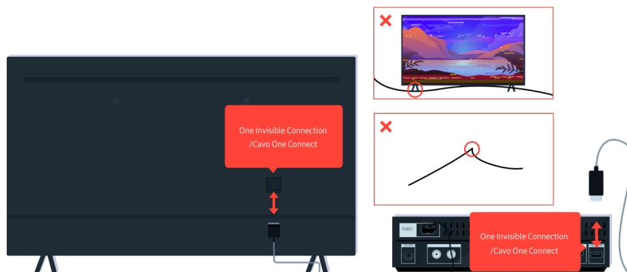
Se il problema persiste e il TV usa One Invisible Connection o Cavo One Connect, scollegare e ricollegare One Invisible Connection o Cavo One Connect al TV e alla One Connect Box. Accertarsi che il One Invisible Connection o Cavo One Connect non sia schiacciato o piegato eccessivamente.
