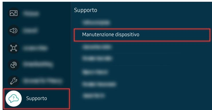
Accedere a > Menu > Impostazioni > Supporto > Manutenzione dispositivo > Auto diagnosi > Test audio per verificare l'audio. [Prova ora](#)
