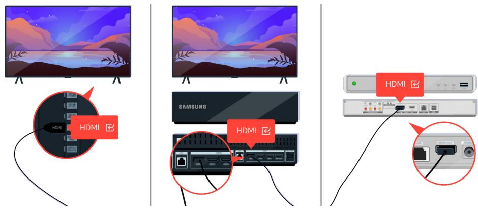
Se il problema persiste, provare a collegare un altro dispositivo esterno al TV mediante un cavo HDMI. Se il display è corretto, il dispositivo esterno potrebbe essere difettoso.
