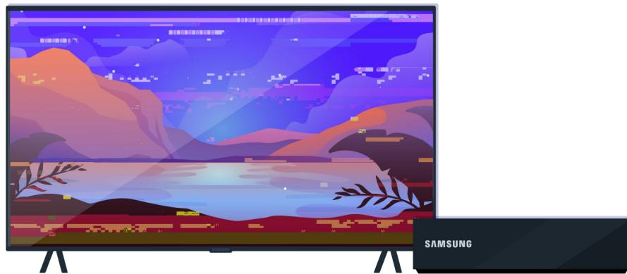
Controllare la connessione dei cavi dell'antenna e degli ingressi.
