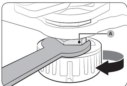
2. Con una chiave da 19 mm (in dotazione) ruotare il **dado di fissaggio (A)** in senso orario per allentarlo. Quindi aprire la porta ed eseguire le seguenti operazioni all'interno della porta.
