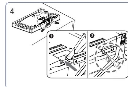
Spingere il piedistallo assemblato nel corpo principale nella direzione indicata dalla freccia come mostrato in figura. Ruotare completamente la vite di collegamento posta sul fondo del piedistallo in modo da fissarlo saldamente.
