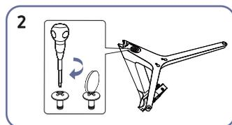
Ruotare completamente la vite di collegamento posta sul fondo del piedistallo in modo da fissarlo saldamente.
