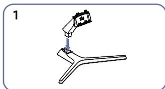
Inserire la base del piedistallo nel connettore seguendo la direzione indicata nella figura. Verificare che il connettore del piedistallo sia saldamente fissato.
