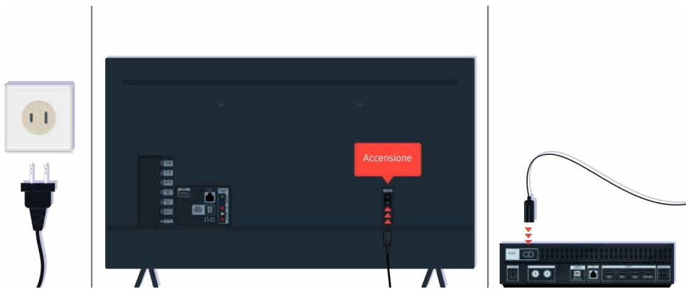
Se il sensore del telecomando non è acceso, scollegare il cavo di alimentazione e ricollegarlo.
