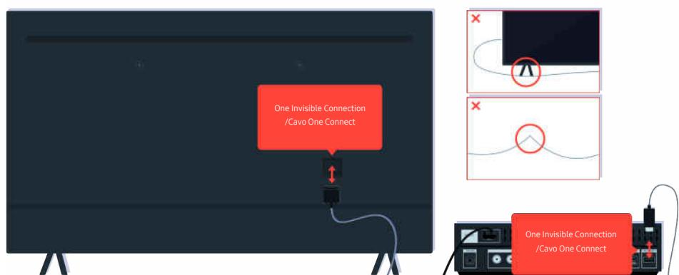
Scollegare e ricollegare il cavo One Invisible Connection o Cavo One Connect tra il TV e la One Connect Box. Accertarsi che il cavo One Invisible Connection o Cavo One Connect non sia schiacciato o piegato eccessivamente.
