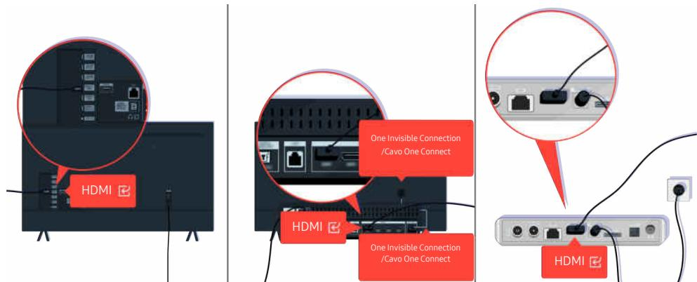
Verificare la connessione del cavo HDMI al proprio TV o alla One Connect Box.
