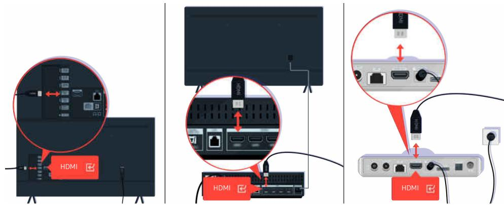
Controllare la connessione dei cavi dell'antenna e delle porte HDMI.
