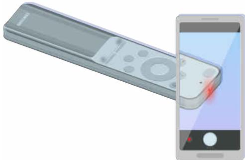
È possibile verificare se il segnale viene trasmesso premendo il tasto di accensione ed osservando il frontalino del telecomando attraverso la telecamera del proprio smartphone.
