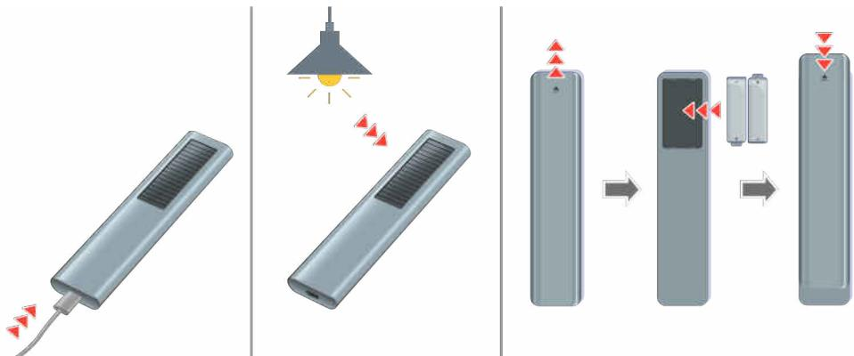
Se non si riesce a vedere i segnali infrarossi, caricare il telecomando usando la porta USB (tipo C) sul fondo, o girare il telecomando per esporre la cella solare. Se il telecomando ha le batterie, sostituirle con delle nuove.
