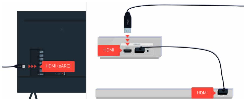
Se la soundbar è collegata a un ricevitore che a sua volta è collegato al TV mediante un cavo HDMI, verificare il connettore HDMI sul retro del TV. Il cavo deve essere collegato alla porta HDMI (eARC) del TV.
