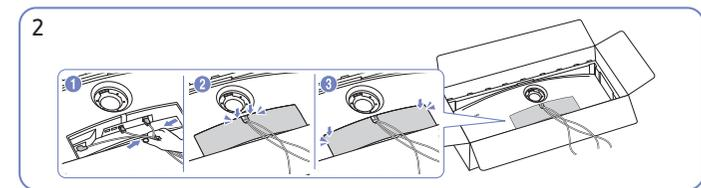
2 Raccogliere i cavi e allinearli con la scanalatura centrale del COPERCHIO POSTERIORE INFERIORE. Montare il COPERCHIO POSTERIORE INFERIORE nella parte posteriore inferiore del prodotto.
