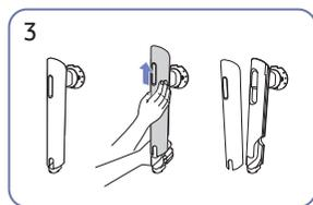
3 Rimuovi il COPERCHIO POSTERIORE DEL CORPO DEL SOSTEGNO tirandolo nella direzione mostrata nella figura.
