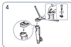
4 Inserisci la base del sostegno nel collo del sostegno seguendo la direzione mostrata nella figura.
