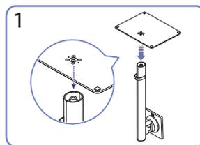
1 Inserire la base del piedistallo nel connettore seguendo la direzione indicata nella figura. Verificare che il connettore del piedistallo sia saldamente fissato.
