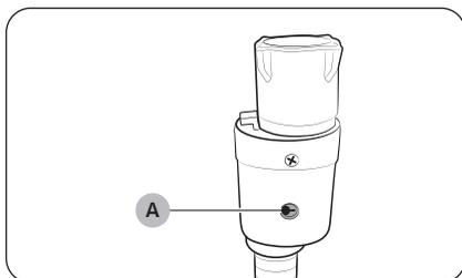
Il tubo Aquastop avvisa l'utente del rischio di perdite d'acqua. Questo dispositivo rileva il flusso dell'acqua e in caso di perdita l'**indicatore (A)** centrale si accende in rosso.
