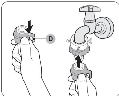
6. Tenendo abbassata la **parte (D)** del tubo dell'acqua, collegare il tubo di carico dell'acqua all'adattatore. Quindi rilasciare la **parte (D)**. Il tubo si inserisce nell'adattatore con uno scatto.
