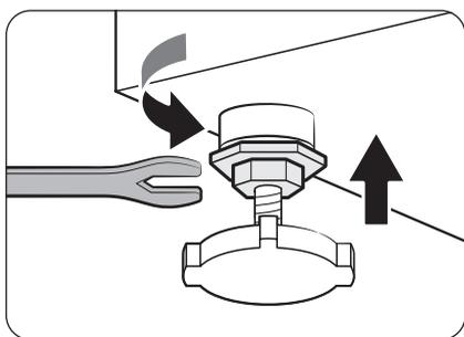
3. Una volta livellata, serrare i dadi mediante la chiave in dotazione.
