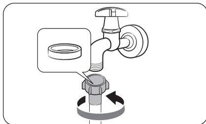
1. Collegare il tubo al rubinetto dell'acqua quindi ruotare il connettore per serrarlo.
