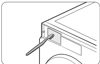
3. Pulire l'interno del cassetto usando una spazzola così da rimuovere eventuali residui di detersivo e di calcare.
