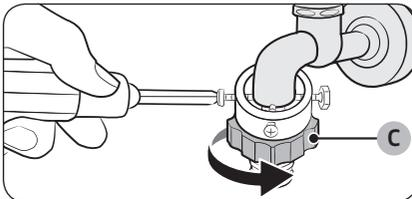
4. Inserire l'adattatore nel rubinetto e serrare le viti sollevando l'adattatore.
