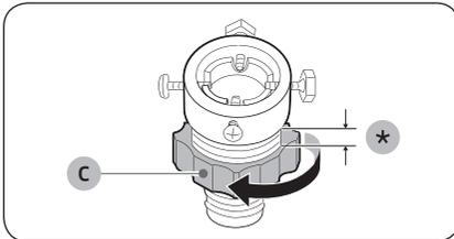
3. Tenendo l'adattatore, ruotare la **parte (C)** in direzione della freccia per allentarlo di 5 mm (\*).
