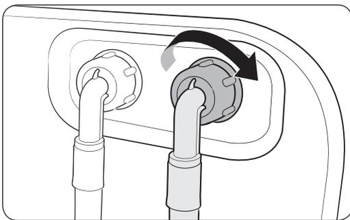
1. Collegare il terminale rosso del tubo di carico dell'acqua calda all'ingresso dell'acqua calda sul retro della lavatrice.
