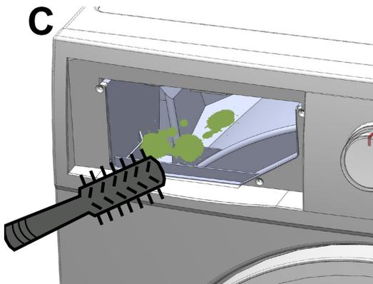
Qualora fosse ostruito da detersivo o da corpi estranei è consigliabile rimuovere l'ostacolo avendo cura di non spingere l'ostruzione a fondo per evitare di intasare il circuito interno. Ricordiamo che il detersivo si rimuove con facilità se trattato con acqua calda.
