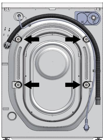
Una volta svitate le viti estrarre le stesse comprensive di boccola e distanziale come mostrato in figura 2.
