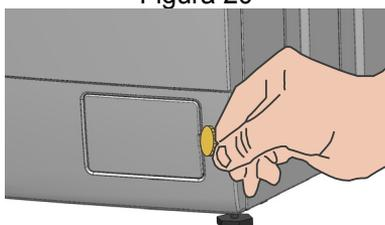
N.B Se lo scarico è intasato, nella macchina può trovarsi una consistente quantità d'acqua (max. 25l).
