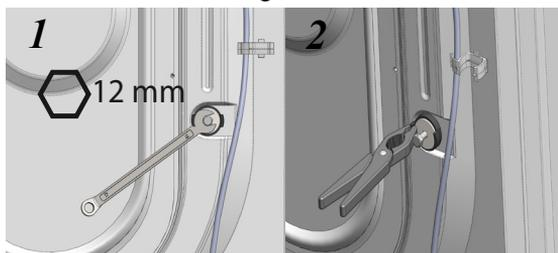
**N.B. Nel caso in cui i distanziali restino all'interno della macchina è necessario aprire il pannello posteriore, recuperarli e rimontare il pannello.**
