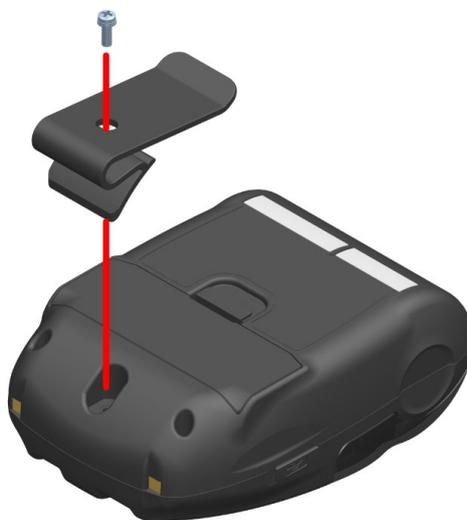
Figura 13-1 Montaggio/smontaggio della clip da cintura
