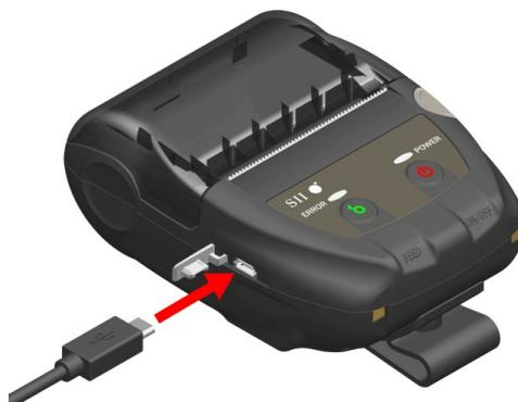
**Figura 8-1 Collegamento stampante e cavo USB**
