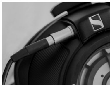
Täydellinen: Yhtenevästi symmetriset liitännät varmistavat luotettavan signaalin siirron kaiutinelementteihin.
