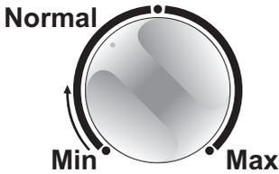
Stellen Sie ihn in eine mittlere Position, um eine für normale Verwendung optimale Temperatur einzustellen. Je weiter Sie den Regler im Uhrzeigersinn drehen, umso geringer wird die Temperatur im Gerät sein. Je weiter Sie den Regler gegen den Uhrzeigersinn drehen, umso höher wird die Temperatur im Gerät sein. Überprüfen Sie das Erreichen der gewünschten Temperatur mithilfe eines Thermometers.
