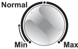
Placez-le en position médiane pour régler la température optimale pour une utilisation normale. Plus vous tournez le bouton dans le sens des aiguilles d'une montre, plus vous baissez la température dans l'appareil. Plus vous tournez le bouton dans le sens contraire des aiguilles d'une montre, plus vous augmentez la température dans l'appareil. Vérifiez avec un thermomètre si l'appareil ont déjà atteint la température souhaitée.
