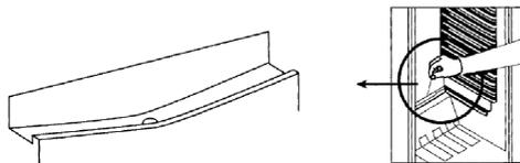
Assicurarsi che il pozzetto di scarico e il foro di scarico non siano in alcun modo ostruiti, in modo da garantire un deflusso continuo e corretto dell'acqua prodotta nel frigorifero.
