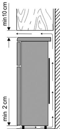
El aire caliente debe circular libremente por detrás del aparato. Por este motivo, no se debe interferir la circulación de aire.
