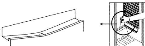
Upewnić się, że kanał ścienny i otwór spustowy nie są zablokowane, aby woda kondensowana w lodówce mogła zawsze odpływać bez przeszkód.
