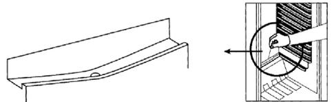
Compruebe que el canal de drenaje y la abertura de drenaje no estén bloqueados para que el agua producida en la nevera pueda siempre fluir sin impedimentos.
