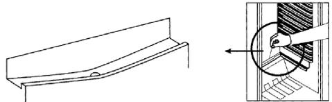
Veuillez à ce que le canal et le trou d'écoulement ne soient pas bouchés afin que l'eau produite dans la chambre froide puisse toujours s'écouler librement.
