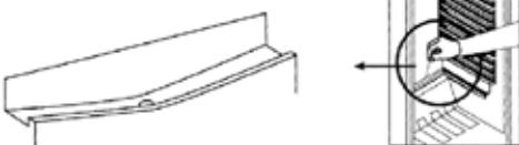
Veuillez à ce que le canal et le trou d'écoulement ne soient pas bouchés afin que l'eau produite dans la chambre froide puisse toujours s'écouler librement.
