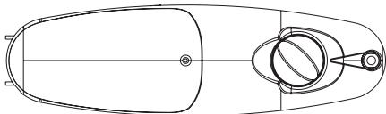
Plaats het in op een middenpositie om de optimale temperatuur in te stellen voor normaal gebruik. Hoe verder u de knop met de wijzers van de klok mee draait, hoe lager de temperatuur in de koelkast. Hoe verder u de knop tegen de wijzers van de klok in draait, hoe hoger de temperatuur in de koelkast zal zijn.
