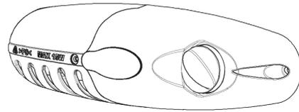
Stellen Sie ihn in eine mittlere Position, um eine für normale Verwendung optimale Temperatur einzustellen. Je weiter Sie den Regler im Uhrzeigersinn drehen, umso geringer wird die Temperatur im Kühlraum sein. Je weiter Sie den Regler gegen den Uhrzeigersinn drehen, umso höher wird die Temperatur im Kühlraum sein.
