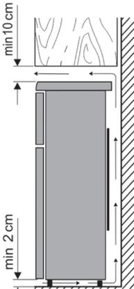
Die hinter dem Gerät aufgewärmte Luft muss frei zirkulieren können. Aus diesem Grund dürfen Sie die Luftzirkulation nicht beeinträchtigen.
