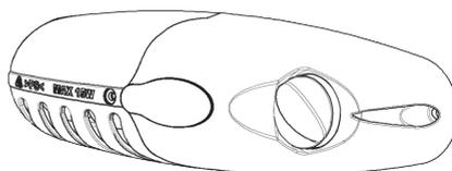
Placez-le en position médiane pour régler la température optimale pour une utilisation normale. Plus vous tournez le bouton dans le sens des aiguilles d'une montre, plus vous baissez la température dans le réfrigérateur. Plus vous tournez le bouton dans le sens contraire des aiguilles d'une montre, plus vous augmentez la température dans le réfrigérateur.
