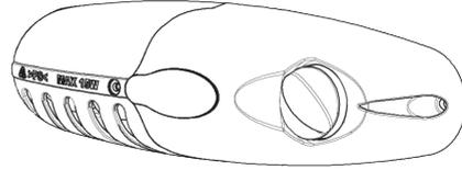
Plaats het in op een middenpositie om de optimale temperatuur in te stellen voor normaal gebruik. Hoe verder u de knop met de wijzers van de klok mee draait, hoe lager de temperatuur in de koelkast. Hoe verder u de knop tegen de wijzers van de klok in draait, hoe hoger de temperatuur in de koelkast zal zijn.
