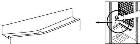
Veuillez à ce que le canal et le trou d'écoulement ne soient pas bouchés afin que l'eau produite dans la chambre froide puisse toujours s'écouler librement.
