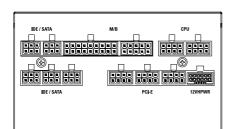
1x 24-pin mainboard (2x M/B) 2x 4+4-pin/8-pin CPU (CPU) 3x 6+2-pin PCIe (PCI-E) 5x SATA (IDE/SATA) 1x 12VHPWR
