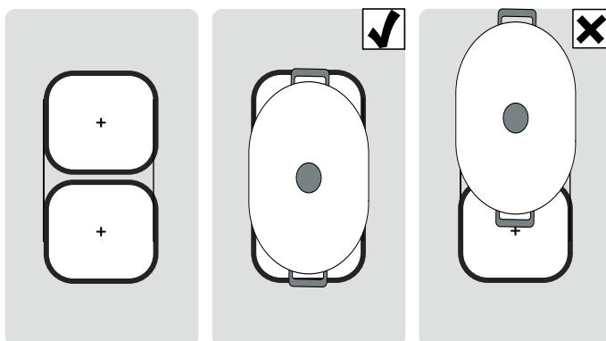
Se su una delle due aree di cottura si utilizza soltanto una stoviglia, è possibile spostarla sulla seconda area. In questo caso vengono mantenuti il livello di potenza e le impostazioni acquisiti.
