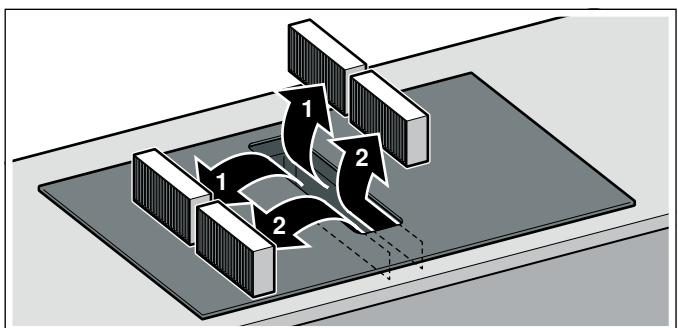
3. Inserire due filtri a carbone attivo, a sinistra e a destra, nell'apparecchio e spostare in avanti.
