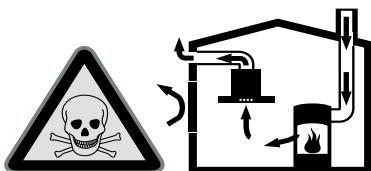
Kooktoestellen die de lucht in de ruimte verbruiken (bijv. apparaten die op gas, olie, hout of kolen worden gestookt, geisers, warmwatertoestellen) trekken de verbrandingslucht uit de ruimte van opstelling en voeren de gassen via een afvoer (bijv. schoorsteen) af naar buiten.
