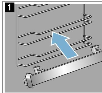
2. Introdurre il supporto posteriormente tra l'asta inferiore e quella superiore (figura 2).
