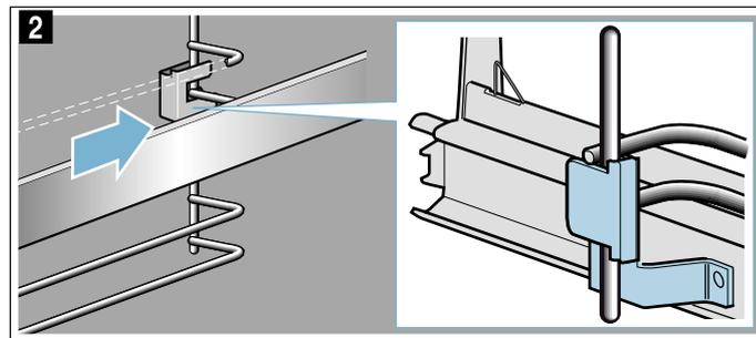
3. Premere "PUSH" e spostare la guida verso l'interno, in modo che il supporto si trovi tra entrambe le aste (figura 3).
