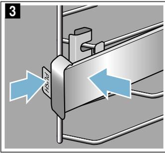
4. Rilasciando "PUSH", il supporto si innesta in posizione (figura 4). Infine estrarre la guida finché non si innesta in posizione e inserirla nuovamente.
