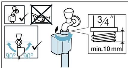
**Consiglio:** Collegare anche un filtro dell'acqua esterno (a seconda del modello) tra il tubo flessibile di alimentazione acqua e il rubinetto. Il filtro filtra le particelle di sporco eliminandole dall'acqua.
