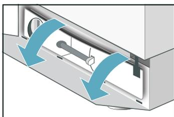
3. Rimuovere il tubo flessibile di scarico dal supporto. Rimuovere il tappo di chiusura e versare l'acqua in un apposito contenitore. Potrebbe essere necessario svuotare numerose volte il contenitore dell'acqua di scarico. Sostituire il tappo di chiusura e collocare il tubo flessibile di scarico nel supporto.
