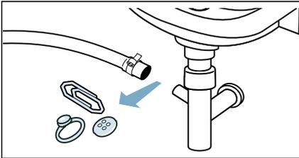
4. Ricollegare il tubo flessibile di scarico e assicurare il punto di collegamento tramite la fascetta del tubo flessibile.
