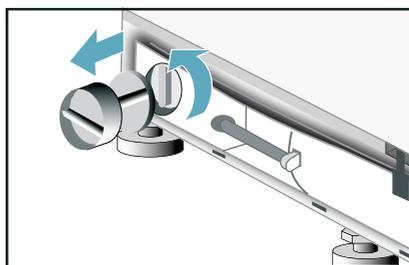
5. Riapplicare il coperchio della pompa e avvitarlo saldamente in posizione. Posizionare il pannello di spinta nelle 4 fessure a clip e fissarlo alla struttura con i perni di bloccaggio.
