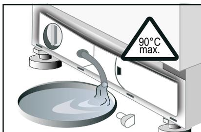
4. Svitare con cautela la copertura della pompa; è possibile la fuoriuscita di acqua residua. Pulire la struttura della pompa e rimuovere qualsiasi oggetto estraneo. La girante all'interno della pompa di scarico deve poter ruotare liberamente.
