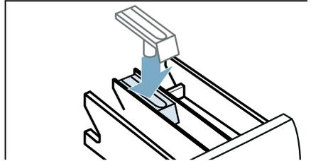
5. Inserire completamente il cassetto del detersivo.
