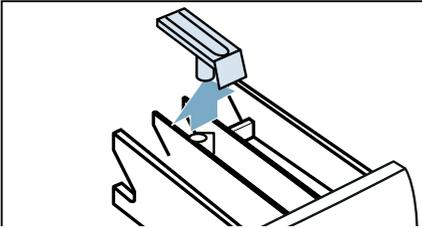
3. Pulire il vano dello scomparto detersivo e l'inserto con acqua e una spazzola e asciugare. Pulire anche l'interno della struttura.
